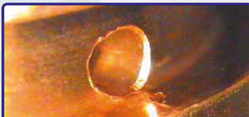
Turbo contraffatto - Scarsa sbavatura e presenza di spigoli, posizione del foro scorretta
