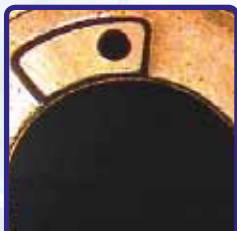
Turbo nuovo/PSO Particolare del cuscinetto di spinta
