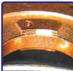
Turbo nuovo/PSO Particolare del cuscinetto di spinta
