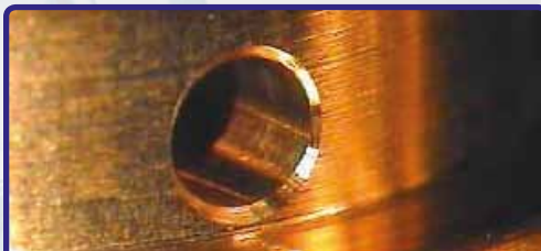
Turbo nuovo/PSO - Foro correttamente sbavato e corretta posizione del foro
