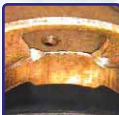
Turbo contraffatto Particolare del cuscinetto di spinta
