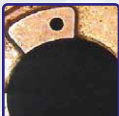
Turbo contraffatto Particolare del cuscinetto di spinta
